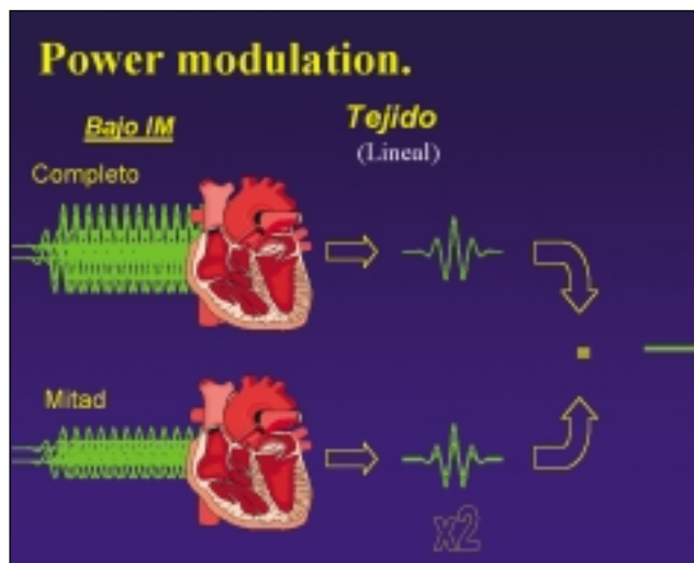
Figura 4.—Comportamiento con «Power modulation» del tejido y las burbujas tras la emisión de un haz de ultrasonido con bajo índice mecánico.
