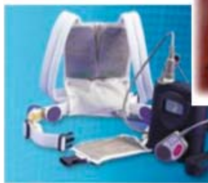
Figura 3.—Componentes del chaleco-DAE. Se puede apreciar el cinturón de electrodos y los parches de desfibrilación, dos a nivel dorsal y uno precordial. En la pistolera se encuentra la unidad de control, monitorización y desfibrilación, con su correspondiente mando de control y respuesta. En la imagen inferior se puede apreciar la disposición final de todo el sistema sobre el paciente.
